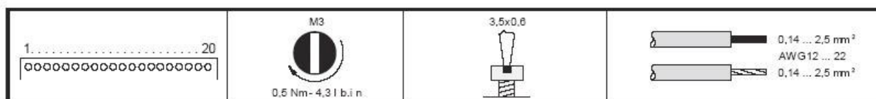
25. ábra: meghúzási nyomatékok és kábelméreték (1 mm = 0,094 inch)
