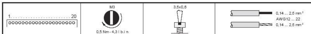
21. ábra: meghúzási nyomatékok és kábelméreték (1 mm = 0,094 inch)
