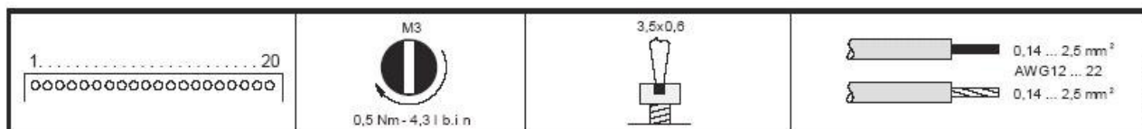
12. ábra: meghúzási nyomatékok és kábelméreték (1 mm = 0,094 inch)
