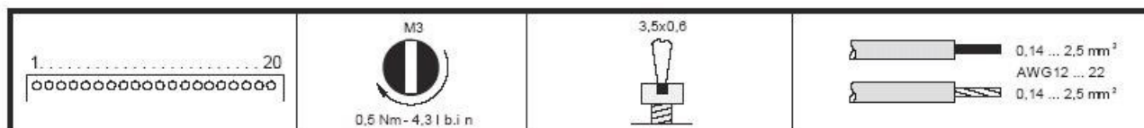
15. ábra: meghúzási nyomatékok és kábelméretek (1 mm = 0,094 inch)
