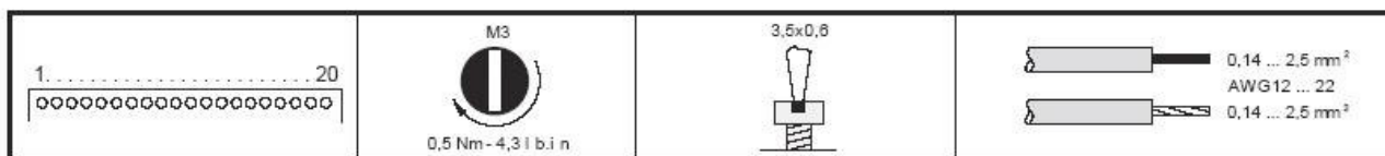
19. ábra: meghúzási nyomatékok és kábelméreték (1 mm = 0,094 inch)
